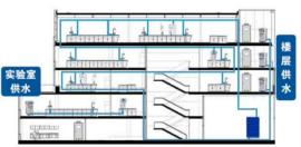
**ZY-CT 系列**中央(超)纯水系统采用了一体式预处理(石英砂+椰壳活性炭+软化树脂)系统、RO 反渗透纯水主机系统、抛光混床或 EDI 电除盐超纯水系统、纯水储存和输送系统等,它是把原水直接处理达到实验分析用水标准,然后输送到不同楼层直接取用水点,方便快捷,水质最佳,电阻率最高可达 18.25MΩ.cm。另外,根据用户高实验分析用水要求,可加配 O<sub>3</sub> 臭氧/UV 紫外灭菌装置、UF 超滤装置、MF 终端微滤装置等以降低水中 TOC值、细菌和热源(内毒素),完全符合 ASTM、CAP、CLSI、EP 和 USP 的最高标准。
